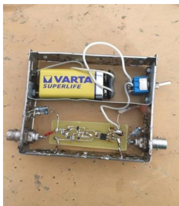
Рисунок 3 – вид на монтаж усилителя
