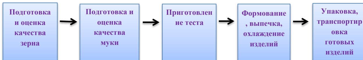
Рис. 1 – Схема производства хлеба и хлебобулочных изделий в ТОО «Ласточка».
