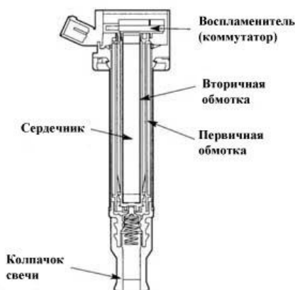
Рисунок 4 - Устройство катушки зажигания в системе COP
