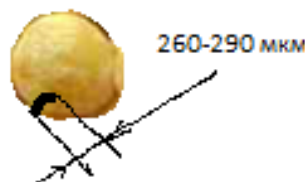
Рисунок 1 – Размер трещины на поверхности зерна гороха
