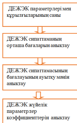
3-сурет. Сызықтық конверсия әдісімен ДЕЖЭК жүйесінің параметрлерін есептеу алгоритмі
