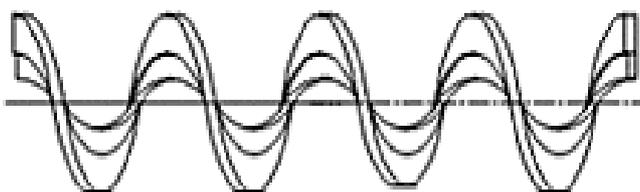
Рисунок 3 - Ленточный безосевой шнек
