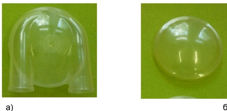
Рисунок 4 – Компоненты ИЖС: а) – корпус ИЖС, полученный методом литья под давлением на термопластавтомате; б) – мембрана ИЖС, полученная методом окунания в ванну с раствором полимера
