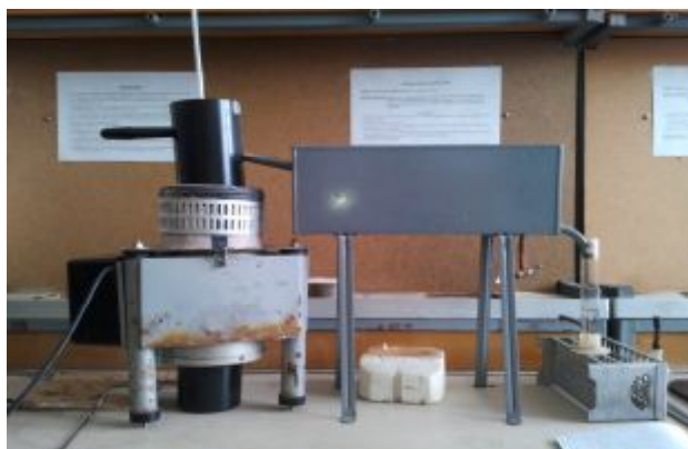
Рисунок 1. Установка определения фракционного состава бензина ЛАФС
