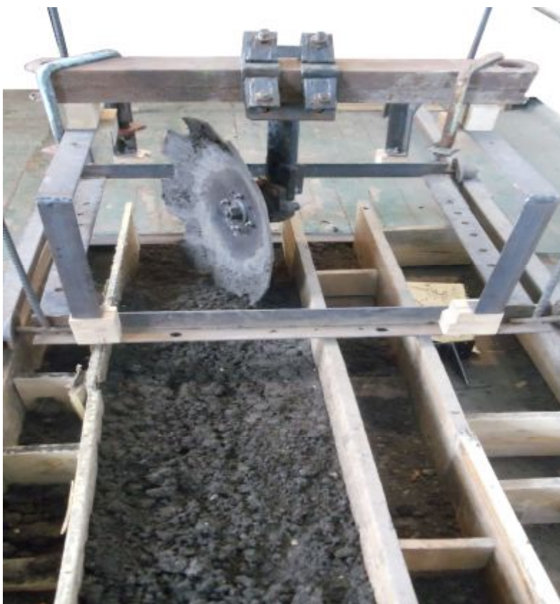
Рисунок 3 – Тележка со смонтированным рабочим органом
