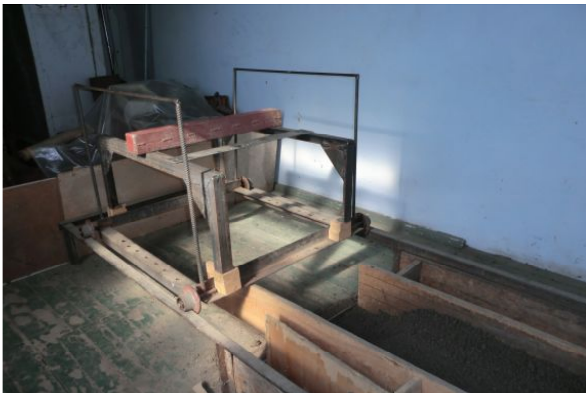
Рисунок 2 – Тележка для монтажа рабочих органов
