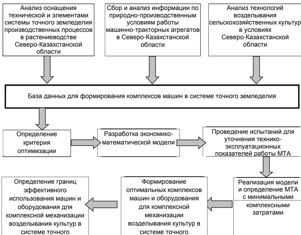
Рисунок 1 – Общая схема выполнения работы по обоснованию оптимальных комплексов машин
