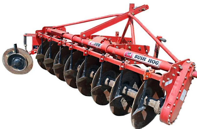
Рисунок 2 – Дисковое орудие с активным приводом (компания Bush Hog, США)
