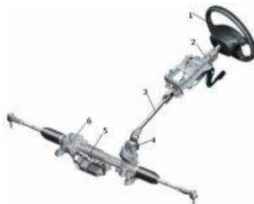
Рисунок 2. Схема рулевого управления: 1 - рулевое колесо; 2 - рулевая колонка; 3 - карданный вал; 4 - датчик крутящего момента на рулевом колесе; 5 - электроусилитель руля; 6 - рулевой механизм; 7 - рулевая тяга; 8 - наконечник рулевой тяги с шаровым шарниром.
