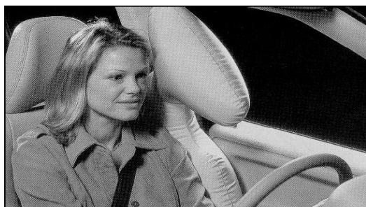
Рисунок 1. Воздушные мешки на Volvo S80: а) мешки для защиты при фронтальных столкновениях; б) мешки для защиты при боковых столкновениях; в) пиротехнически надуваемые шторы для защиты головы.
