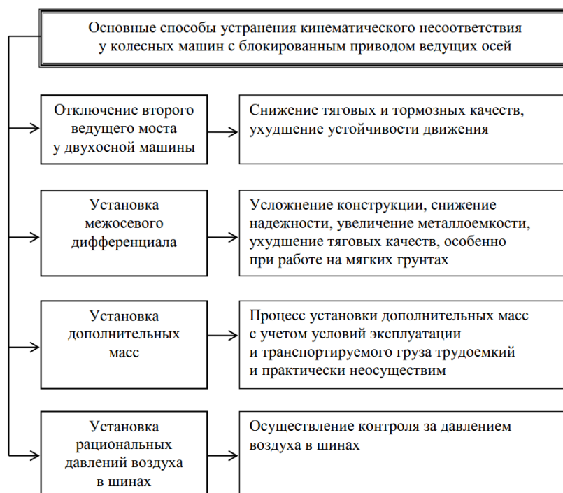
Рисунок 2 - Основные пути исключения кинематического несоответствия у колесных машин с заблокированным приводом ведущих осей
