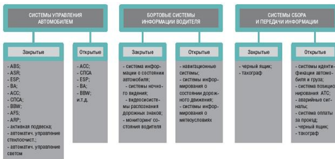
Рисунок 3 – Блок-схема классификации бортовых систем интеллектуального автомобиля.
