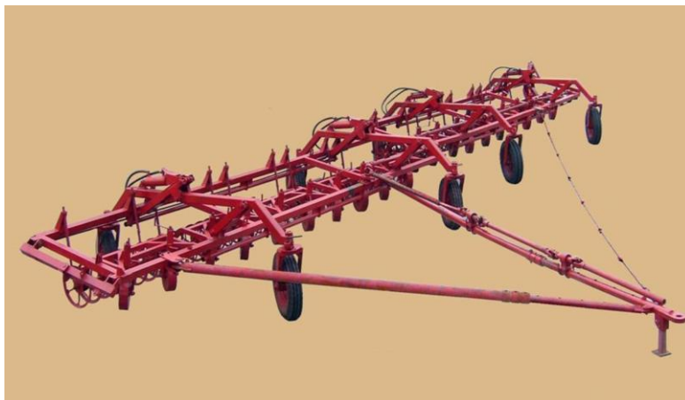
Рисунок 1 – Орудие с активным приводом прорезных дисковых рабочих органов (Костанайский филиал КазНИИМЭСХ, Казахстан)
