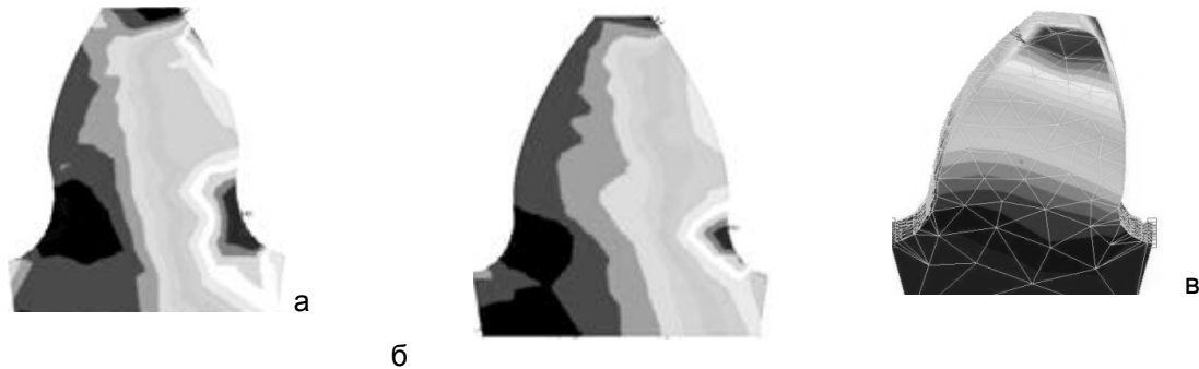
Рисунок 4. Распределение напряжений в зубе. а) при явлении подрезания зуба; б) при явлении заострения зуба; в) при оптимальном варианте коэффициента смещения.
