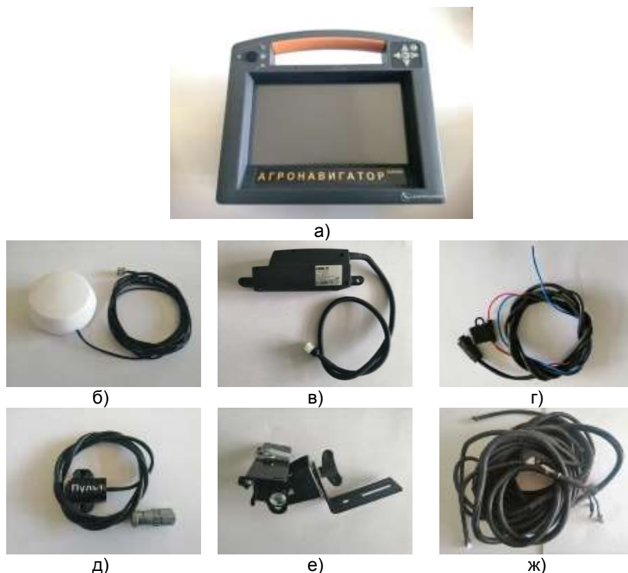
а – «Агронавигатор плюс»; б – ГЛОНАС/GPS антенна; в – актуатор; г – кабель питания; д – внешний пульт управления; е – кронштейн крепления агронавигатора; ж – соединительные кабеля
