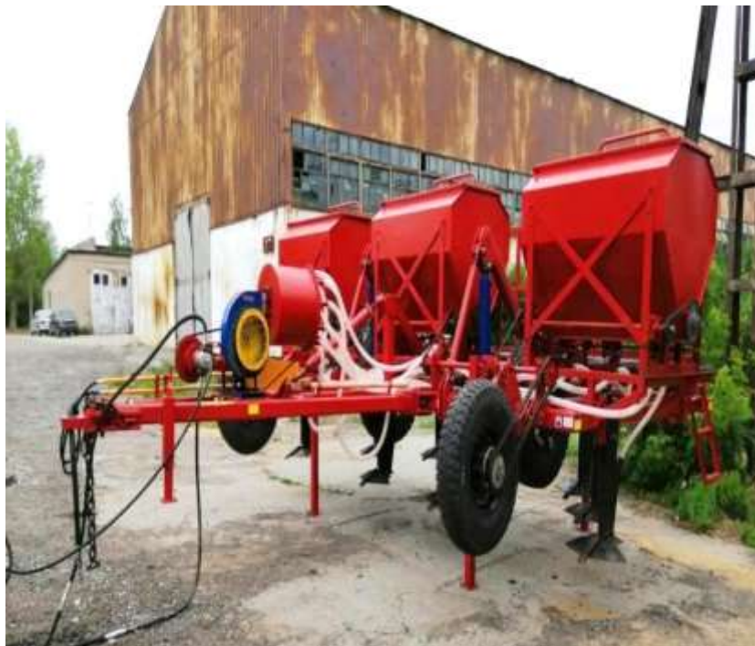
Рисунок 1 – Орудие для внутрипочвенного внесения минеральных удобрений, оборудованного системой дифференцированного внесения минеральных удобрений. Общий вид
