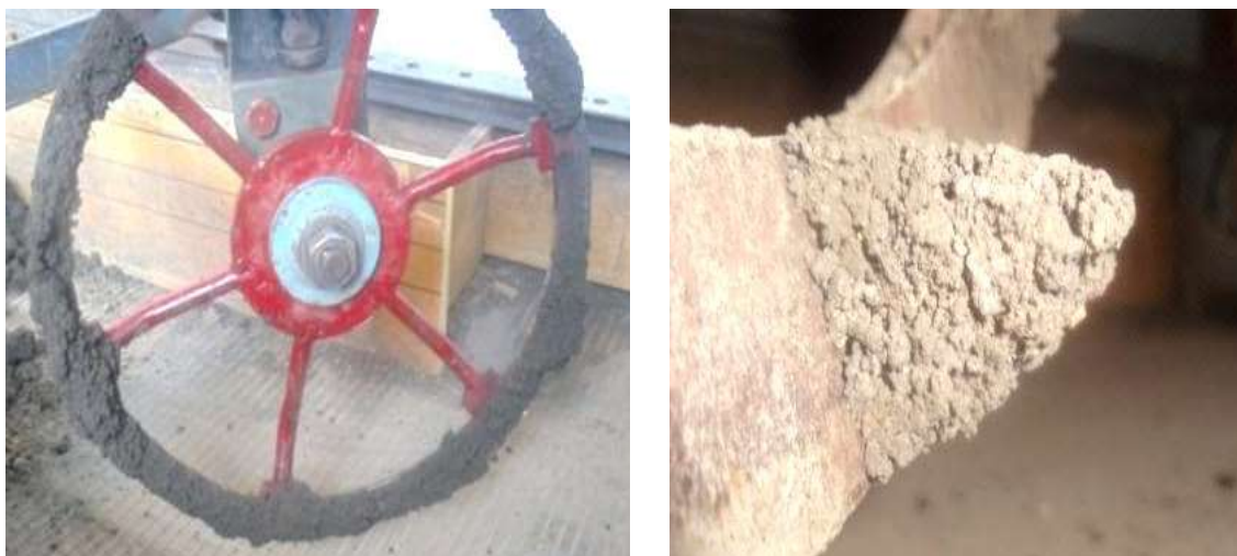
а – общий вид рабочего органа с почвенным образованием; б – поперечное сечение почвенного образования
