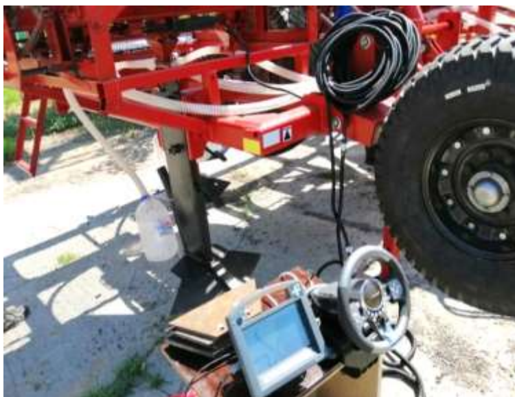
Рисунок 3 – Общий вид системы дифференцированного внесения минеральных удобрений с установленным симулятором
