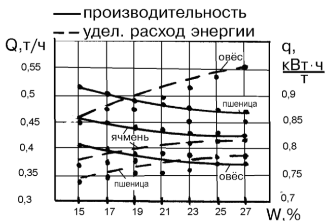
Рисунок 4 - Зависимость производительности и удельного расхода энергии от влажности зерна при ( V=120 м/с; l=150 мм; b=35 мм; S=3 мм; \beta=0,8 ).
